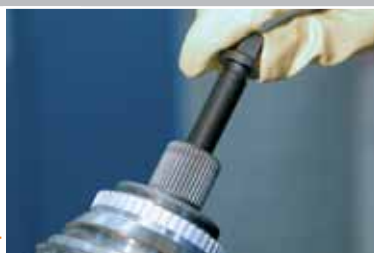
Вкрутите резьбовые штифты в профильный вал.
