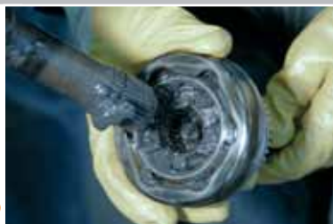
Стяните гофрированный чехол. Очистите шарнир от старой смазки.
